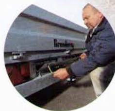
Rangement des rampes de chargement sous le plateau. (Accessoires)
